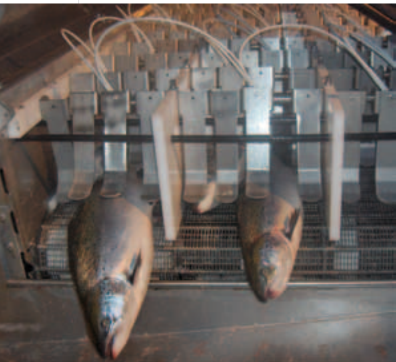
Figur 5. Elektrisk bedøving av laks i elektrobedøver fra Stansas. Bildet er tatt idet fisken kommer ut på bløgebordet. Foto: Cecilie Mejdell
