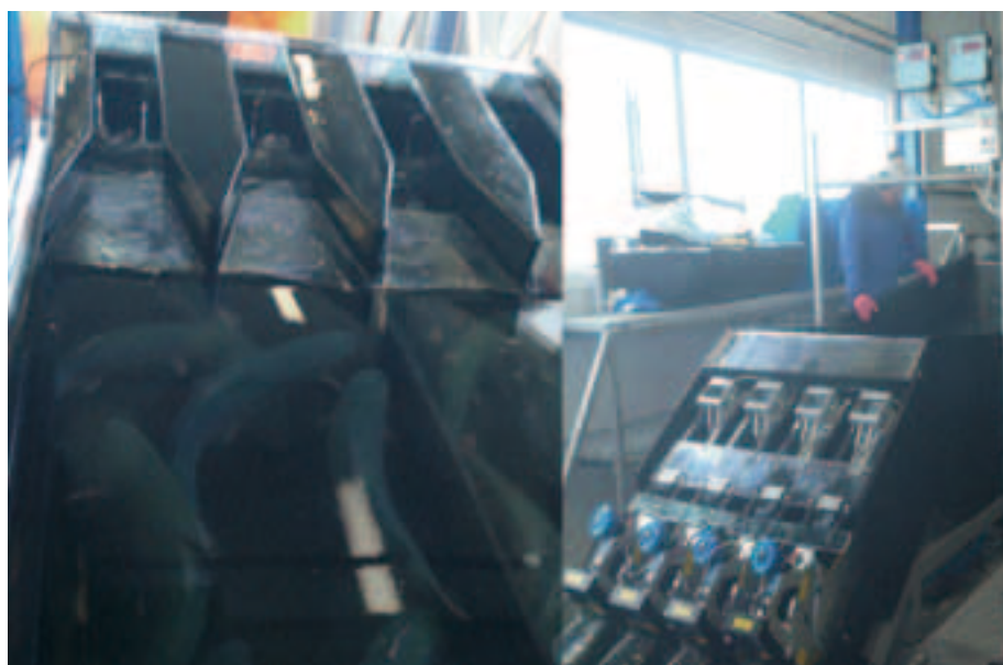
Figur 4. Helautomatisk slagbedøving med SI-5. Bildet til venstre viser fisk i vannkaret, med utgangene i bakgrunnen, der fisken skal svømme aktivt ut. Bildet til høyre viser selve slagmaskinene, med 4 enheter. Foto: Ulf Erikson og Cecilie Mejdell.
