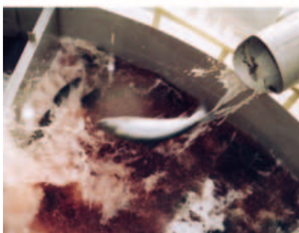
Figur 3. Levendekjøling uten annen bedøving. Det øverste bildet viser "skruen" i en RSW levendekjølingstank (bak) og utblødningstanken der fisken slippes etter bløgging (foran til høyre). Bildet under viser fisk idet den pumpes over i levendekjølingstanken, her med tydelig rødfarget vann. Foto: Ulf Erikson.
