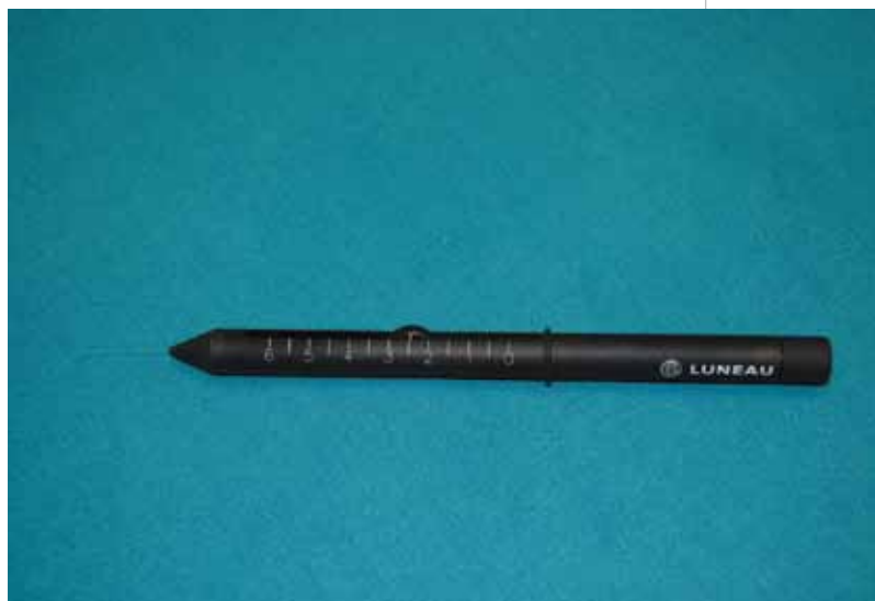
Figur 3: Cochet-Bonnet estesiometer. (Foto: H. Løkke-Sørensen)
