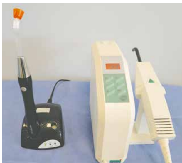
Figur 11: Eksempel på LED herdelampe (venstre), (Mectron), og Halogenlampe (høyre), (Saltec). Begge lampene har innebygd radiometer for å måle effekt. Foto: S. Storli
