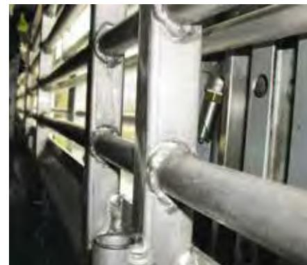
*Figur 6. Ibland är vattennipplarna helt enkelt utan räckhåll för djuren. Foto: Alexander Rabitsch*
